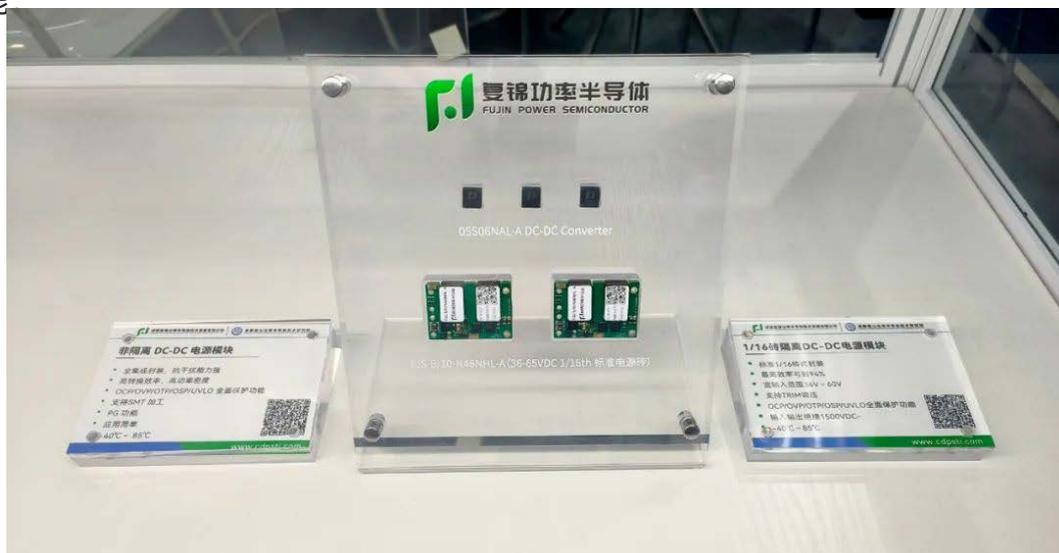
超宽高压直流电源模块，具有超宽输入电压范围、高效率、高可靠性的特点。该系列电源模块应用创新性电路设计，实现超宽输入范围 200 至 1500V，可广泛应用于 SVG、光伏、高压变频等高压场合，为设备提供稳定的工作电压。且其自带的多重保护功能可提升模块电源工作异常情况下电源及其负载的安全性能。
